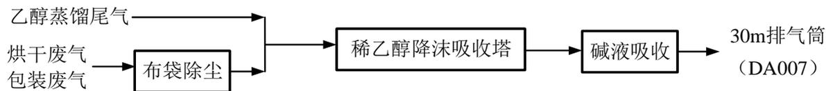
图 4.4.2-2 干燥、包装废气处理工艺流程简图
