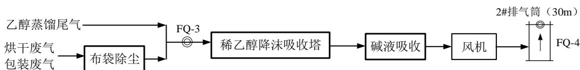
图 7.1.2-2 烘干、包装废气监测点位图
