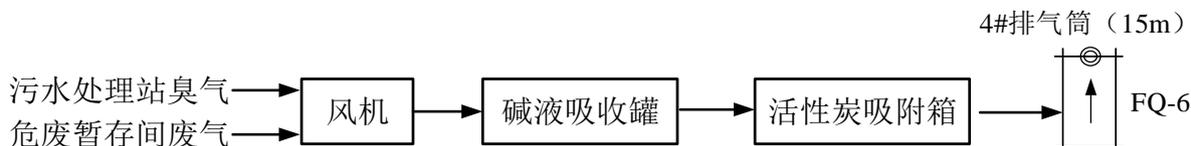
图 7.1.2-3 污水处理站废气监测点位图
